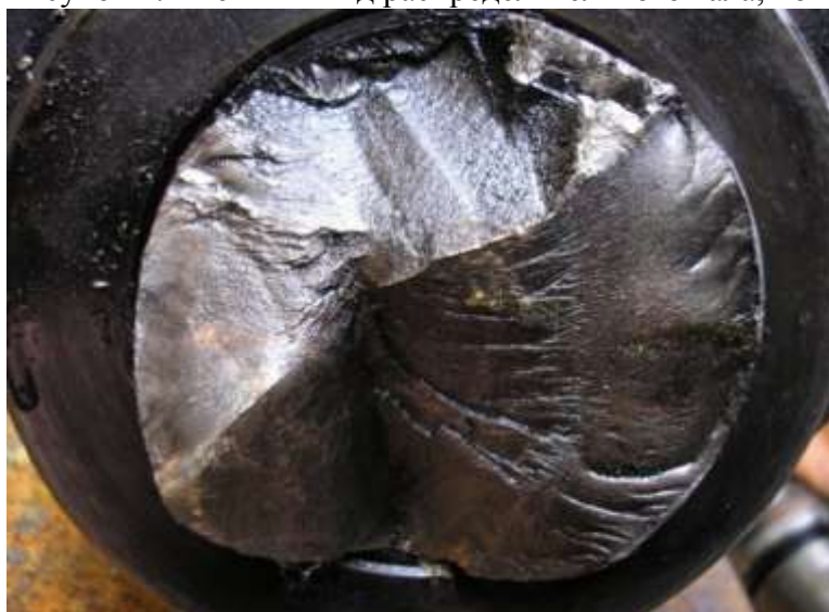
Рисунок 1. Внешний вид распределительного вала, поперечный излом
