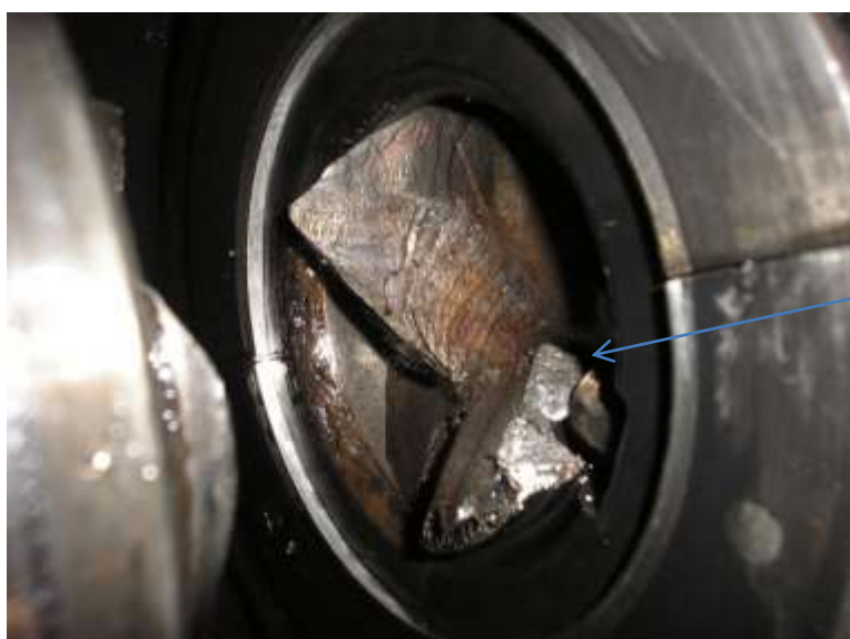
Рисунок 1. Внешний вид распределительного вала, поперечный излом
